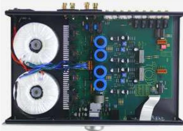
Schéma entièrement symétrique à composants discrets, configuration double mono après redressement, étages différentiels d'entrées à transistors bipolaires, étages de sorties à transistors MOS-FET.
