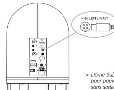
> Dôme Subwoofer est équipé d'une entrée haut-niveau pour pouvoir être connecté à un amplificateur 2 canaux sans sortie subwoofer RCA.
