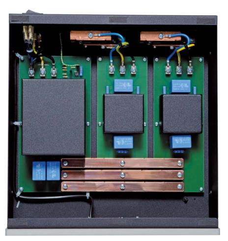
Nous remarquons les deux cartes de filtrage desservant chacune deux connecteurs de sortie et les imposantes barres de distribution en cuivre pur poli.
